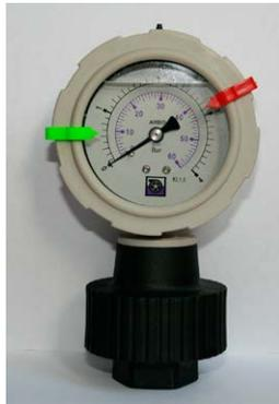
Die große Membranfläche in Kombination mit der geringen Zusammendrückbarkeit der Pufferflüssigkeit sorgt für eine genaue Anzeige.
